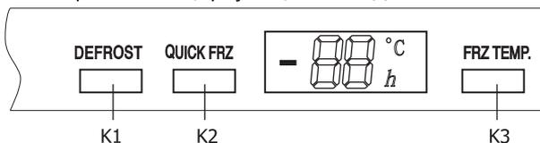
После включения прибора на дисплее (LED) будет указана исходная температура — “-18°C”.
